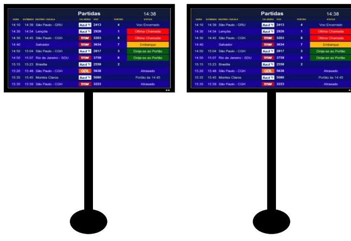
Modelo 4 - As telas são fixadas em suporte duplo preso ao piso
