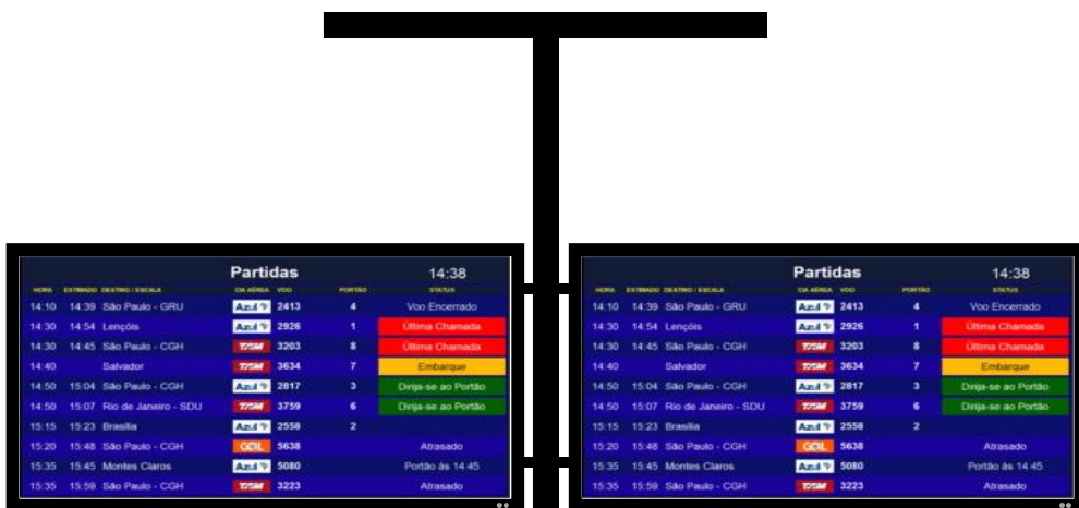
Modelo 1 - As telas são fixadas em suporte único.
